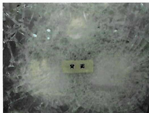
图四: 高温条件下, 防弹复合玻璃中弹后, 背面弹伤状态
