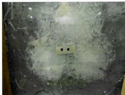
图二: 常温条件下, 防弹复合玻璃中弹后, 背面弹伤状态
