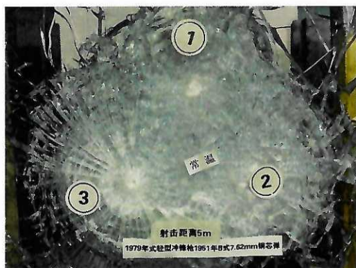
图一: 常温条件下, 防弹复合玻璃中弹后, 正面弹伤状态
