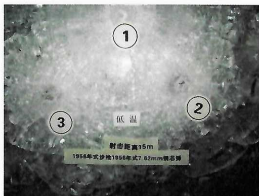
图五: 低温条件下, 防弹复合玻璃中弹后, 正面弹伤状态
